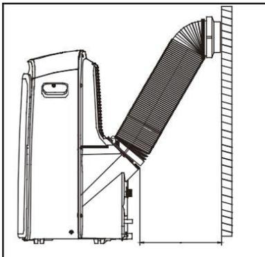
**Das Gerät muss 24 Stunden aufrecht stehen, bevor es in Betrieb genommen wird. Ansonsten besteht die Gefahr eines Kompressorschadens.**
